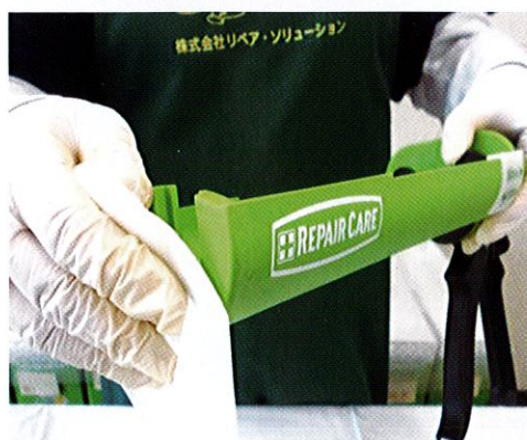
押出ガン機のクリーニング
